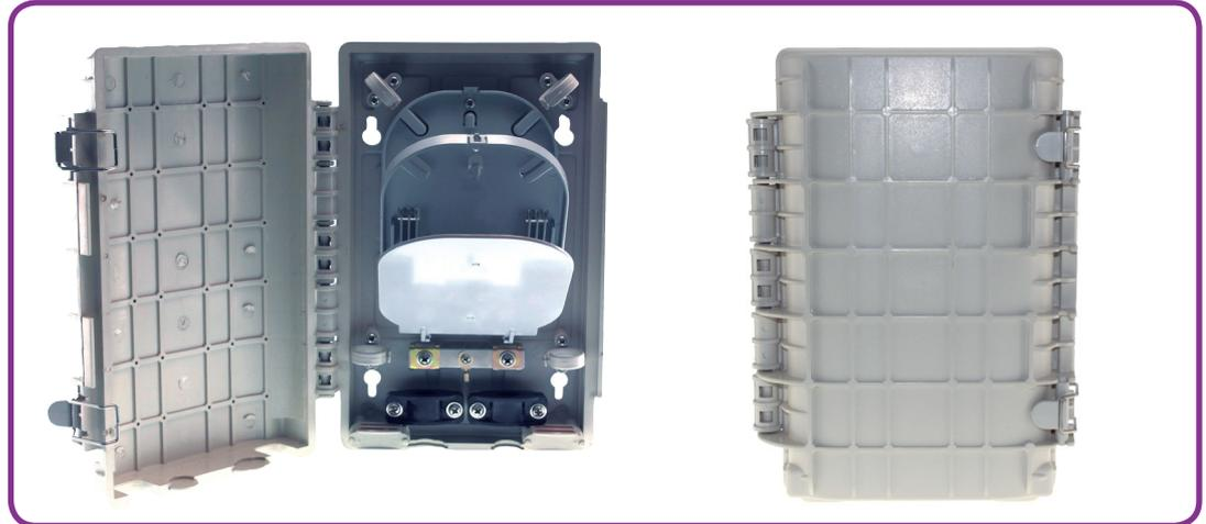
Caja de empalme y distribución plástica robusta y fácil de operar. Dispone de 2 puertos de entrada, 24 puertos de salida para usuarios y 2 bandejas empalme para 6 fibras cada una. El sistema de bandejas apilables permite instalar 2 más para llegar a las 24 fusiones. La caja dispone de todos los elementos necesarios para una correcta canalización y fijación de las fibras.
