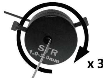
Mantenga firme el disco que sujeta la entrada de cable, y gire en sentido inverso al que lleva la cubierta metálica helicoidal del cable un mínimo de 3 vueltas.
