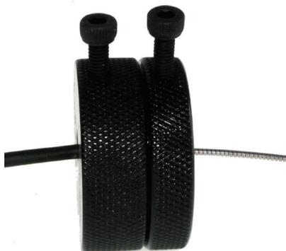
Una vez retirada la cubierta exterior y cortado el kevlar, introducir el cable según indica la fotografía.
